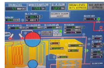
ภาพแสดงการควบคุมโดย Level transmitter C
